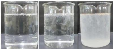
第3図 バッチリ FG の崩壊過程(0.1g)
